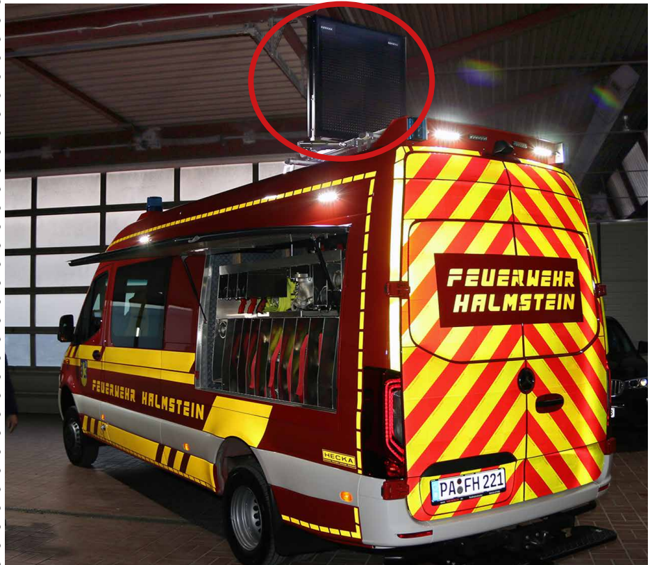
Signalgeber für verkehrslenkende Einsätze z. B. auf der Autobahn und eine besondere Reflektorlackierung machen das Fahrzeug weithin sichtbar
