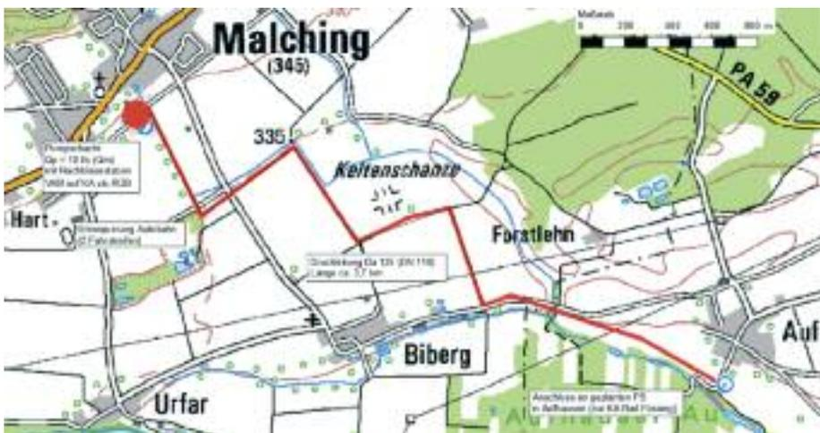
Geplanter Verlauf des Abwasserkanals von der Kläranlage bis Aufhausen.
